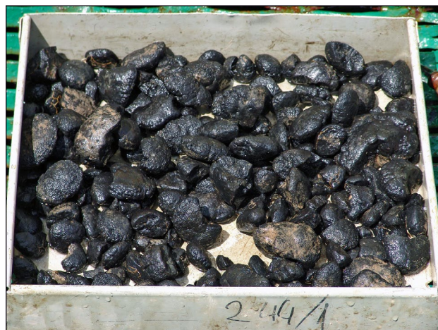
Obr. 2. Vzorka polymetalických konkrécií po vyzdvihnutí z morského dna a očistení (Zdroj: SO IOM, 2009).
