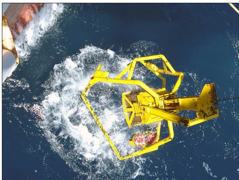
Obr. 5. Vzorkovacie zariadenie (tzv. box-corer) je po odbere vzorky z morského dna vyzdvíhané na palubu lode (Zdroj: SO IOM, 2009).
